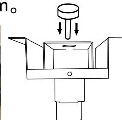
第三步:將膠輪穿過110mm開孔並貼合鋁轉盤,然後將馬達鐵架固定於下桌面下方,調整膠輪高度,膠輪上緣不得高於鋁轉盤。(本步驟完成後才能開動電源)
