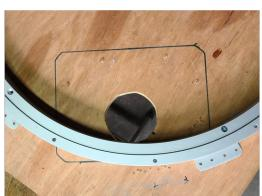
第二步:固定平面上貼近鋁轉盤內緣處開孔110mm。
