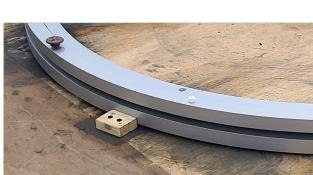
第一步:將鋁轉盤放在下桌面上方,置中放好後,以角材於鋁轉盤外緣固定轉盤位置。
