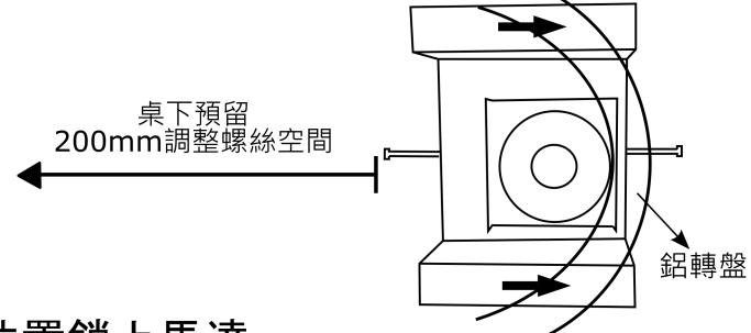
第四步:馬達上箭號方向應指向轉盤,根據膠輪位置鎖上馬達,
